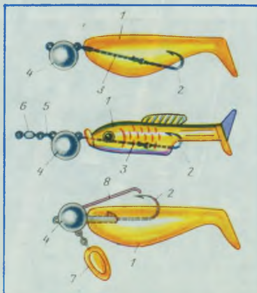
Рис. 3. Способы оснастки виброхвоста: 1 — тело рыбки; 2 — крючок (двойной или одинарный вниз); 3 — проволока; 4 — свинцовое грузило (10—30 г); 5 — заводное колечко; 6 — карабин; 7 — дополнительный лепесток; 8 — противозацепный усик.
